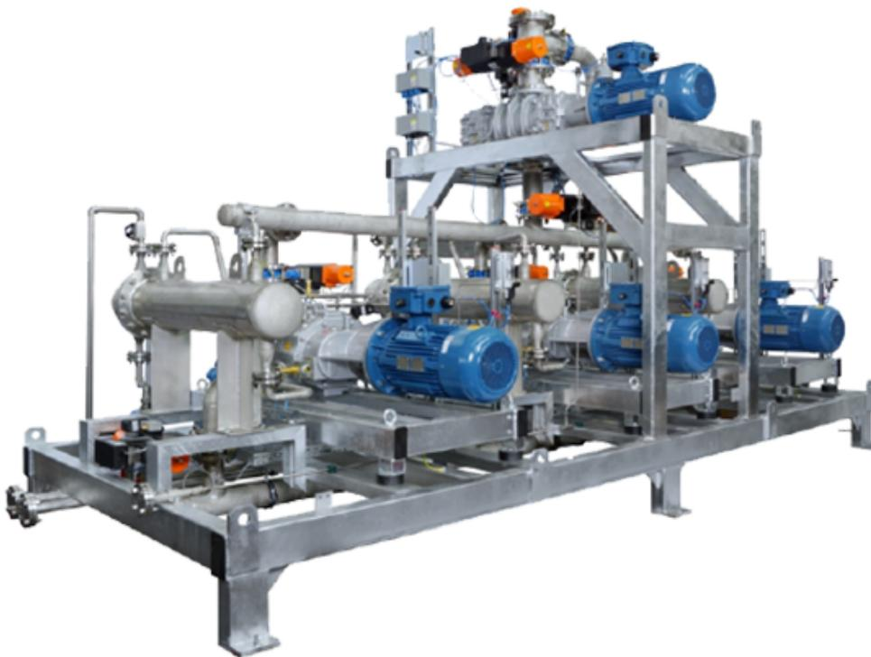
Вакуумная система для производства трет-бутилакрилата (ТВА)
