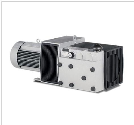
Ротационно-пластинчатый насос безмасляный с подшипниками по обе стороны ротора. Фланцевый двигатель с гибкой торсионной муфтой. Производительность от 100 до 155 м<sup>3</sup>/ч (58,8 - 91,2 куб. футов в минуту), предельный вакуум 150 мбар (абс.). Высокая эффективность и бесшумная работа. Шумопоглощающий кожух обеспечивает выход охлаждающего воздуха. Простота сервисного обслуживания и эксплуатации.
