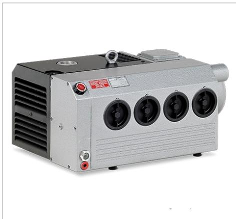
Маслозаполненный ротационно-пластинчатый вакуумный насос производительностью от 50 до 1 535 м<sup>3</sup>/ч (29,4 - 902,9 куб. футов в минуту), предельный вакуум до 0,1 мбар абс. Фланцевый двигатель, подшипники по обе стороны ротора, воздушно-масляный теплообменник. В стандартную комплектацию насосов с объемным расходом от 150 м<sup>3</sup>/ч входит мелкоячеистый фильтр, вакуумный обратный клапан, газобалластный клапан и масляный сепаратор.
