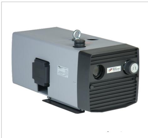
Ротационно-пластинчатый насос безмасляный со встроенным всасывающим воздушным фильтром. Шумопоглощающий кожух обеспечивает снижение уровня шума, улучшает охлаждение и защищает оператора от контакта с горячими поверхностями. Возможность гибкого соединения, низкий уровень пульсации, простота управления, техобслуживания и установки. Производительность от 17,0 до 50,4 м<sup>3</sup>/ч (10,0 - 29,6 куб. футов в минуту), предельный вакуум 150 мбар (абс.).
