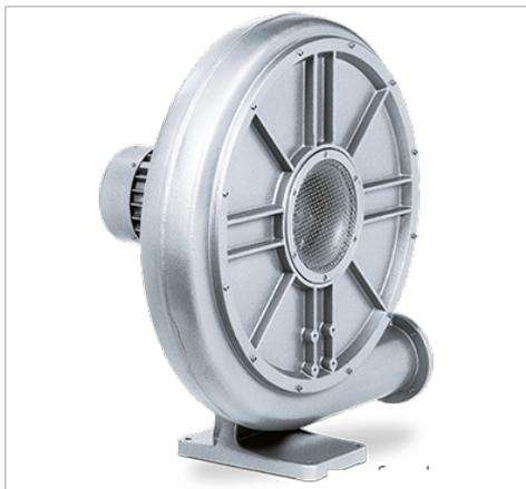
Центробежные воздуходувки производительностью от 4,9 до 57 м<sup>3</sup>/мин (172,9 - 2011,8 куб. фут./мин) для осуществления операций с применением вакуума до 95,5 мбар. Прочная легкая конструкция. Низкий уровень вибрации, тихая работа. Подшипники со смазкой на весь срок службы, необслуживаемые. Двигатели соответствуют DIN EN 60034, оснащены защитой IP 54 и изоляцией класса F.
