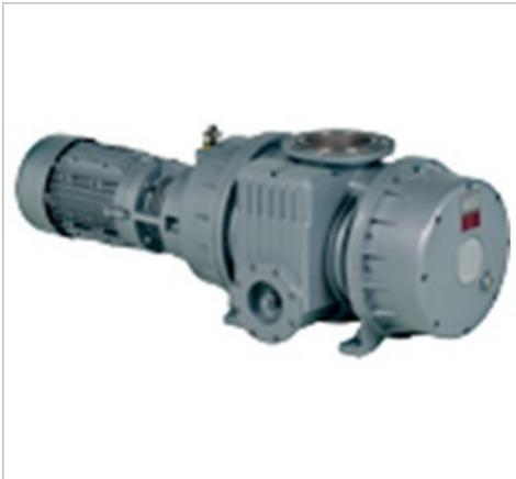
Бесконтактная воздуходувка с двумя (R-WVB 25) или тремя (R-WVB 120 8300) кулачковыми роторами предназначена для осуществления операций с применением вакуума, максимальный вакуум 0,5 бар (абс.). R-WVB (01): базовый агрегат со свободным концом вала, без двигателя. R-WVB (30): компактный агрегат. R-WVB (70): компактный агрегат с шумопоглощающим кожухом. Низкие уровни шума и пульсации, высокая эффективность благодаря оптимальной скорости, устойчивая конструкция, простота сервисного обслуживания.
