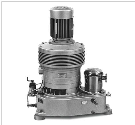
Двухступенчатый ротационно-пластинчатый вакуумный насос вертикальной конструкции. Производительность от 27 до 120 м<sup>3</sup>/ч (15,9 - 70,6 куб. футов в минуту). Предельный вакуум 0,5 мбар (абс.). Смазка свежим маслом защищает насосную камеру от агрессивных паров. Можно использовать в сочетании с вакуумным насосом с кулачковыми роторами.
