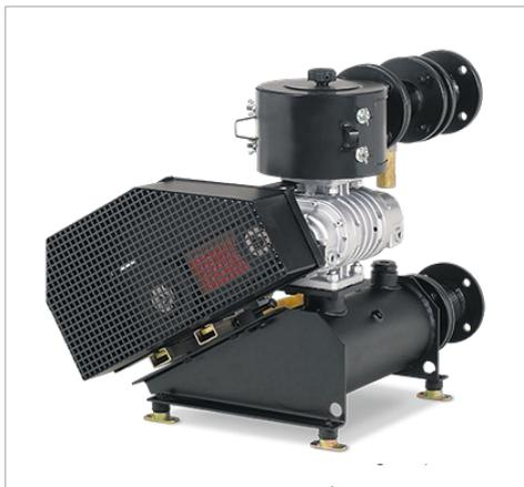
Бесконтактная воздуходувка с двумя (R-WVB 25) или тремя (R-WVB 120 8300) кулачковыми роторами предназначена для осуществления операций с применением вакуума до 0,5 бар (абс.). Поставляются воздуходувки с производительностью в диапазоне от 22 до 8580 м<sup>3</sup>/ч (129 - 5049,4 куб. фут./мин) 16 различных типоразмеров. Низкие уровни шума и пульсации, высокая эффективность благодаря оптимальной скорости, устойчивая конструкция, простота сервисного обслуживания.
