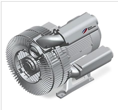
В стандартную комплектацию агрегатов серии G-VH2 входят высокоэффективные приводные двигатели (класс эффективности 1 - eff1), которые оснащены катушками с переменной частотой вращения и имеют широкий диапазон напряжений, что позволяет использовать их во всем мире в различных сетях электроснабжения с преобразователями частоты до 100 Гц (6000 об/мин).
