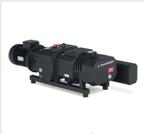
Бесконтактные винтовые вакуумные насосы без смазки производительностью от 100 до 360 м<sup>3</sup>/ч (58,8 - 211,8 куб. футов в минуту), предельный вакуум 0,1 мбар (абс.). Простота сервисного обслуживания. Особенно актуальны для таких областей применения, как упаковка или сушка. Низкая рабочая температура за счет постепенного изменения шага винтовой резьбы.
