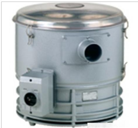
Многоступенчатые центробежные воздуходувки для осуществления операций с применением вакуума, оснащенные фильтром и пылеулавливателем. Модели F-CEVF (29) подходят для удаления бумажного порошка и пыли. Производительность до 5 м<sup>3</sup>/мин (до 176,5 куб. футов в минуту). Общий перепад давлений до 90 мбар. Двигатели соответствуют DIN EN 60034, оснащены защитой IP 54 и изоляцией класса F.
