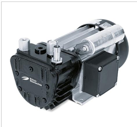
Небольшие ротационно-пластинчатые насосы безмасляные. Компактная конструкция, простота монтажа. Низкие уровни шума, устойчивые к коррозии роторы. В стандартную комплектацию входят шланговый соединитель и выходной глушитель. Производительность от 3,5 до 12 м<sup>3</sup>/ч (2,1 - 7,1 куб. футов в минуту). Предельный вакуум 150 мбар (абс.).
