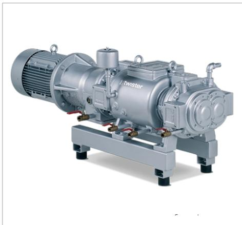
Бесконтактные винтовое вакуумные насосы без смазки производительностью от 105 до 720 м<sup>3</sup>/ч (61,8 - 423,5 куб. футов в минуту), предельный вакуум 0,05 мбар (абс.). Простота сервисного обслуживания. Предлагаются различные покрытия для повышения коррозионной стойкости. Особенно актуально для процессов извлечения растворителя и сушки.
