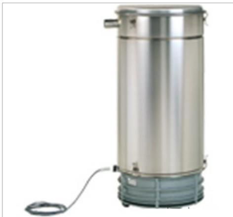
Многоступенчатые центробежные воздуходувки для осуществления операций с применением вакуума, оснащенные верхней фильтрующей емкостью и собирательным бункером. Модели F-CEVF (31) подходят для удаления полос и кусочков бумаги и пленки. Производительность от 4,5 до 7,8 м<sup>3</sup>/ч (157,6 - 275,3 куб. футов в минуту). Общий перепад давлений до 70 мбар. Двигатели соответствуют DIN EN 60034, оснащены защитой IP 54 и изоляцией класса F.
