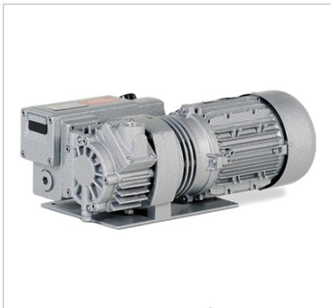
Маслозаполненный ротационно-пластинчатый вакуумный насос производительностью от 20 до 26,5 м<sup>3</sup>/ч (11,8 - 15,6 куб. футов в минуту), предельный вакуум до 2 мбар (абс.). Разработан для установки в небольшие машины для вакуумной упаковки. Фланцевый двигатель, подшипники по обе стороны ротора, воздушное охлаждение. В стандартную комплектацию входит мелкоячеистый фильтр, вакуумный обратный клапан и масляный сепаратор.
