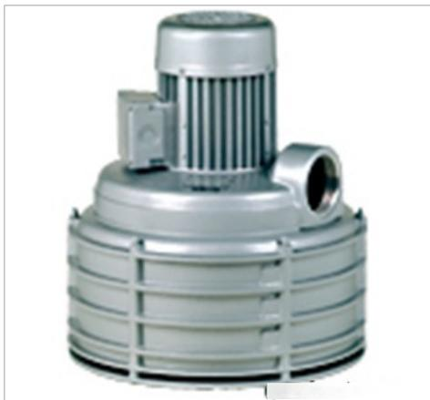
Центробежные воздуходувки с тремя или пятью ступенями для осуществления операций с применением вакуума и давления. Производительность от 3,2 до 8,9 м<sup>3</sup>/мин (111,8 - 314,1 куб. фут./мин) и вакуум до 115 мбар. Компактная конструкция, низкая температура даже при закрытом дроссельном клапане. Быстрый запуск благодаря легким рабочим колесам. Двигатели соответствуют DIN EN 60034, оснащены защитой IP 54 и изоляцией класса F.
