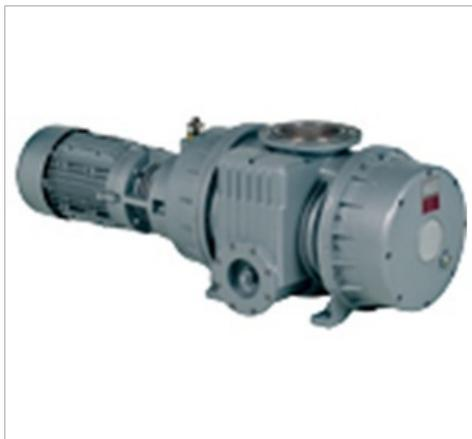
Бесконтактная воздуходувка с двумя (R-WVB 25) или тремя (R-WVB 120 8300) кулачковыми роторами предназначена для осуществления операций с применением вакуума, максимальный вакуум 0,5 бар (абс.). R-WVB (01): базовый агрегат со свободным концом вала, без двигателя. R-WVB (30): компактный агрегат. R-WVB (70): компактный агрегат с шумопоглощающим кожухом. Низкие уровни шума и пульсации, высокая эффективность благодаря оптимальной скорости, устойчивая конструкция, простота сервисного обслуживания.
