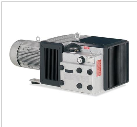
Ротационно-пластинчатый насос безмасляный с подшипниками по обе стороны ротора. Производительность от 55 до 153 м<sup>3</sup>/ч (32,4 - 90 куб. футов в минуту). Предельный вакуум 150 мбар (абс.). Высокая эффективность и бесшумная работа. Шумопоглощающий кожух обеспечивает выход охлаждающего воздуха только с одной или с обеих сторон. Простота сервисного обслуживания и эксплуатации.
