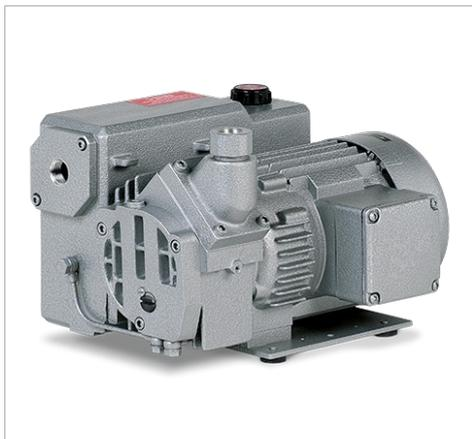
Маслозаполненный ротационно-пластинчатый вакуумный насос производительностью от 10 до 18 м<sup>3</sup>/ч (5,9 - 10,6 куб. футов в минуту). Предельный вакуум выбирается оператором: 2 мбар (абс.) для высокого вакуума или 10 мбар (абс.) для низкого вакуума. Занимает небольшое пространство за счет консольной конструкции ротора и встроенного двигателя. В стандартную комплектацию входит мелкоячеистый фильтр, вакуумный обратный клапан и масляный сепаратор. Очень тихая работа.
