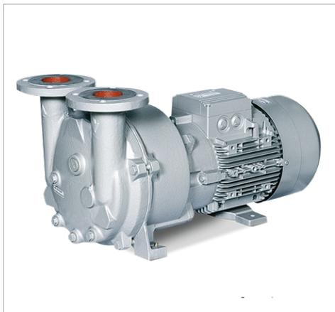
Блочные насосы семейства L-BV5 характеризуются очень большим объемом всасывания до 600 м<sup>3</sup>/ч при давлении всасывания до 33 мбар (абс.) и в первую очередь используются в тех областях, где требуется работа с большими количествами жидкостей. L-BV5 также одновременно является конденсатором и всасывает конденсирующийся пар. Это позволяет удвоить объем всасывания. Уровень звукового давления остается в пределах 73 дБ(А), то есть соответствует самым строгим требованиям к показателям шума.
