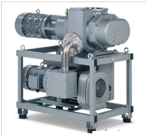
Насосный агрегат состоит из V-VC и вакуумного насоса с кулачковыми роторами. Предназначен в первую очередь для создания высокого вакуума для общепромышленного оборудования. Предельный вакуум 0,01 мбар (абс.)
